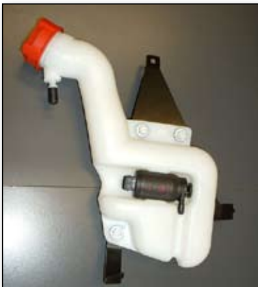
Réservoir d'essence de 5 à 7 litres ajouté au circuit d'alimentation
