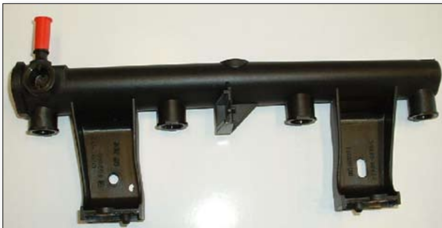
Rampe d'injection de Peugeot 206 Bioflex
