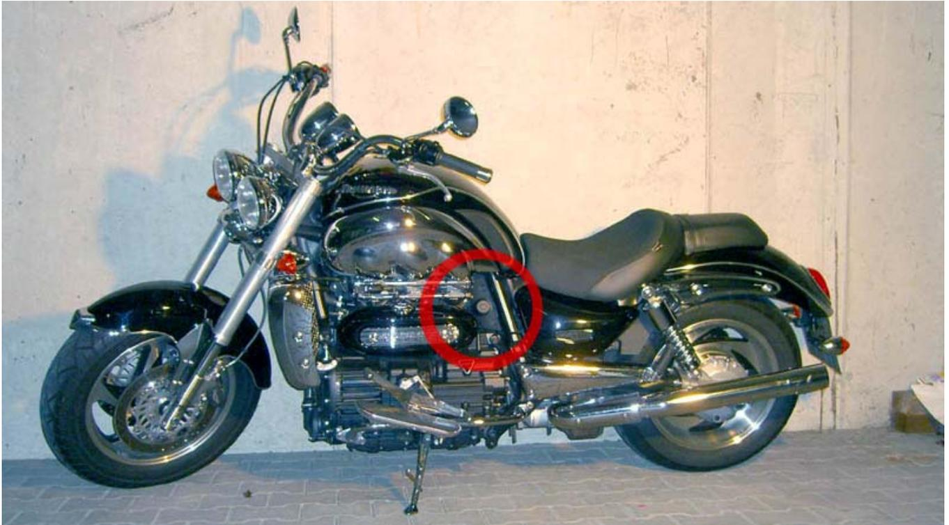
Info: Der Gangstellungs-/Leerlaufsensor befindet sich direkt neben dem Kardan am hinteren Teil des Getriebes.
